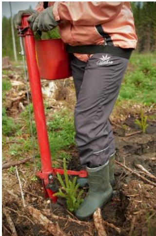
Joonis 1. Istutustoru
